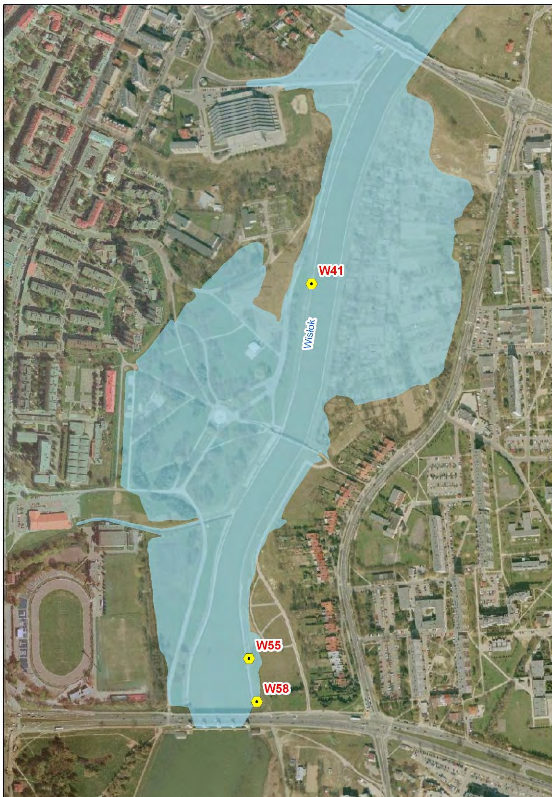
Ryc. 138. Lokalizacja wylotów kanalizacji deszczowej do Wisłoka - cz. 1
