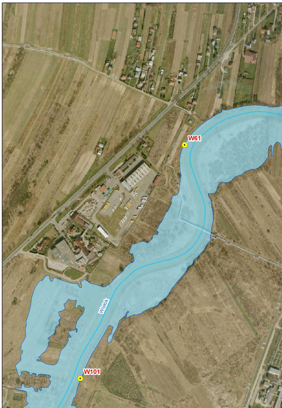
Ryc. 144. Lokalizacja wylotów kanalizacji deszczowej do Wisłoka - cz. 4
