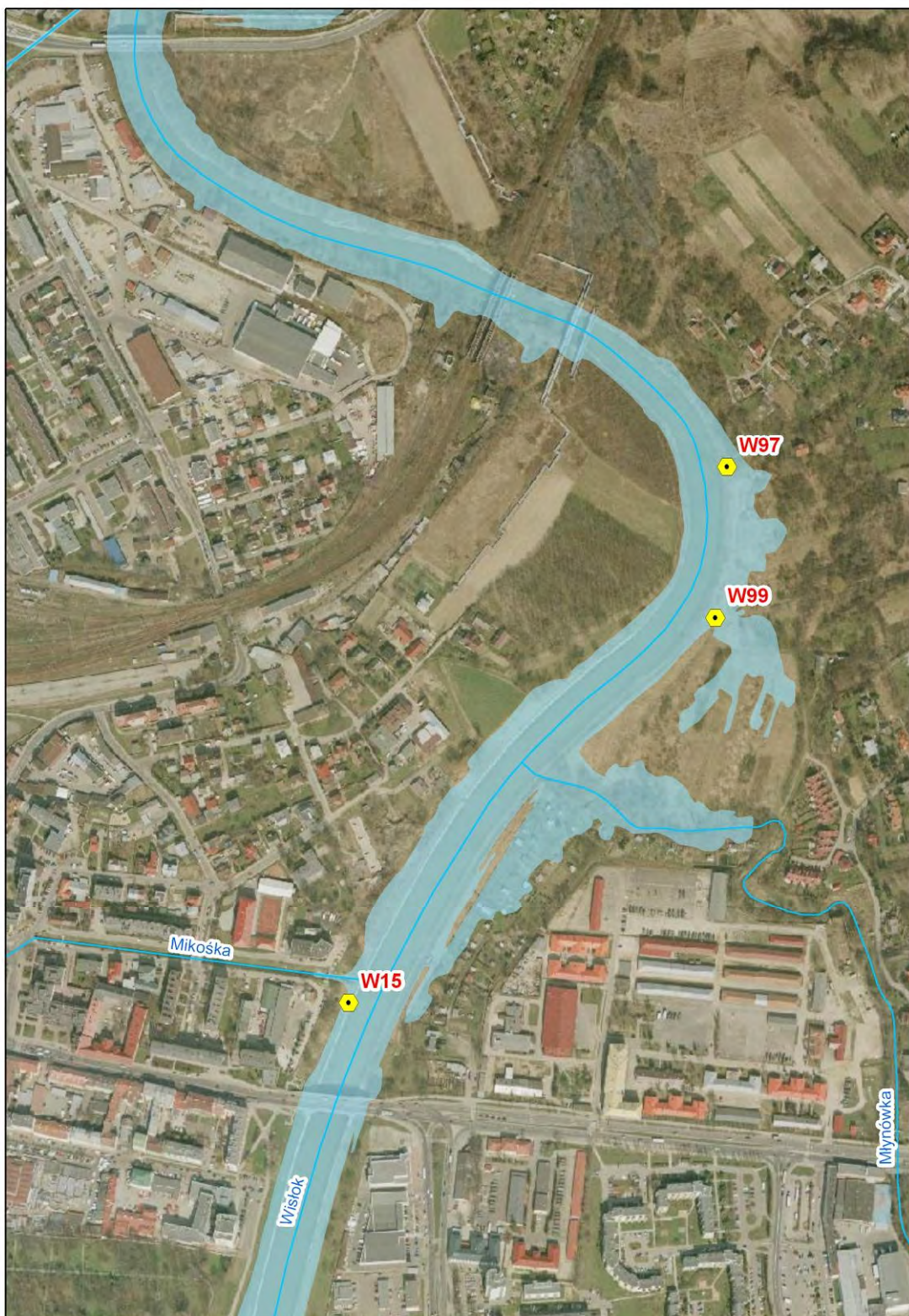
Ryc. 140. Lokalizacja wylotów kanalizacji deszczowej do Wisłoka - cz. 2
