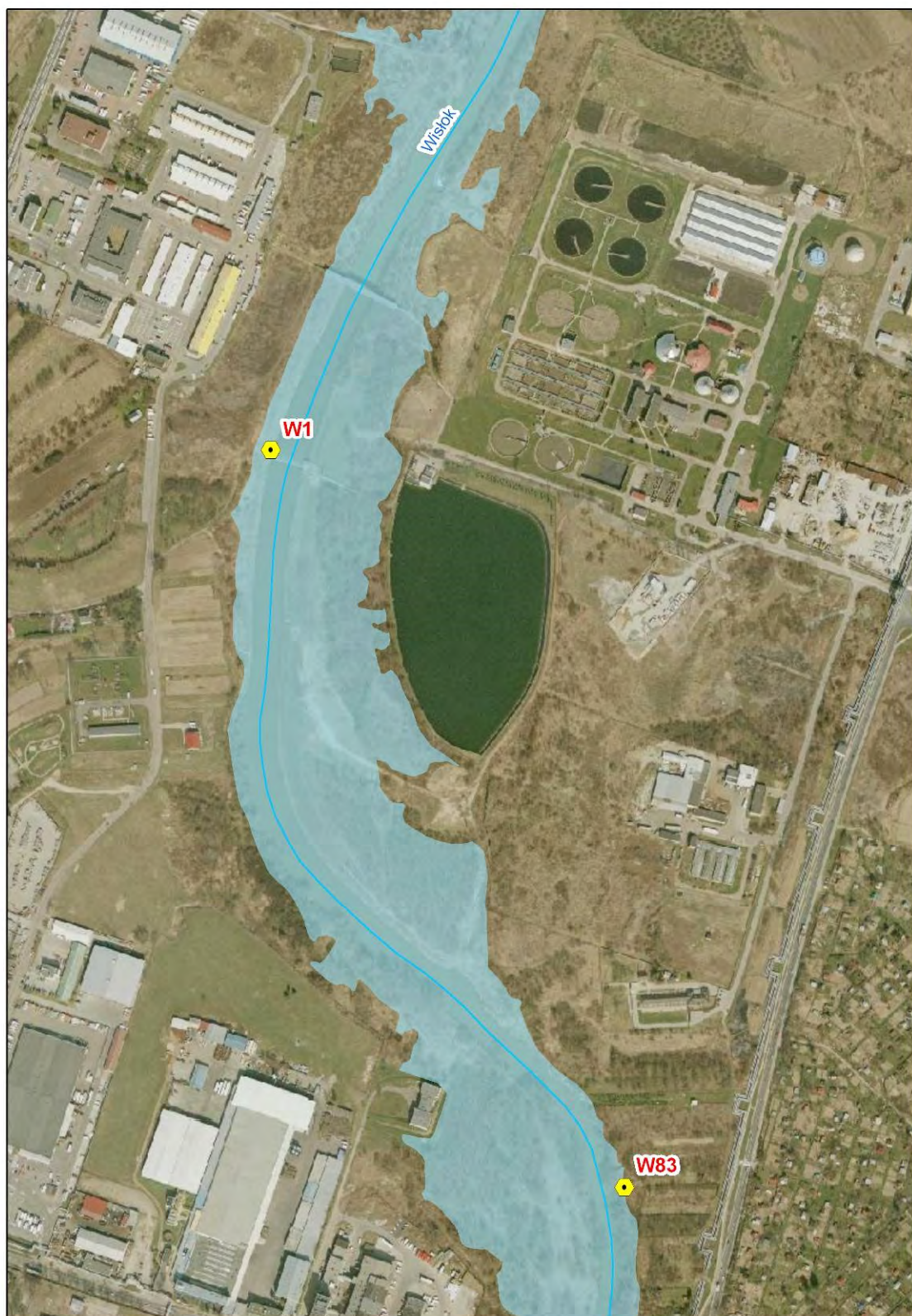
Ryc. 142. Lokalizacja wylotów kanalizacji deszczowej do Wisłoka - cz. 3
