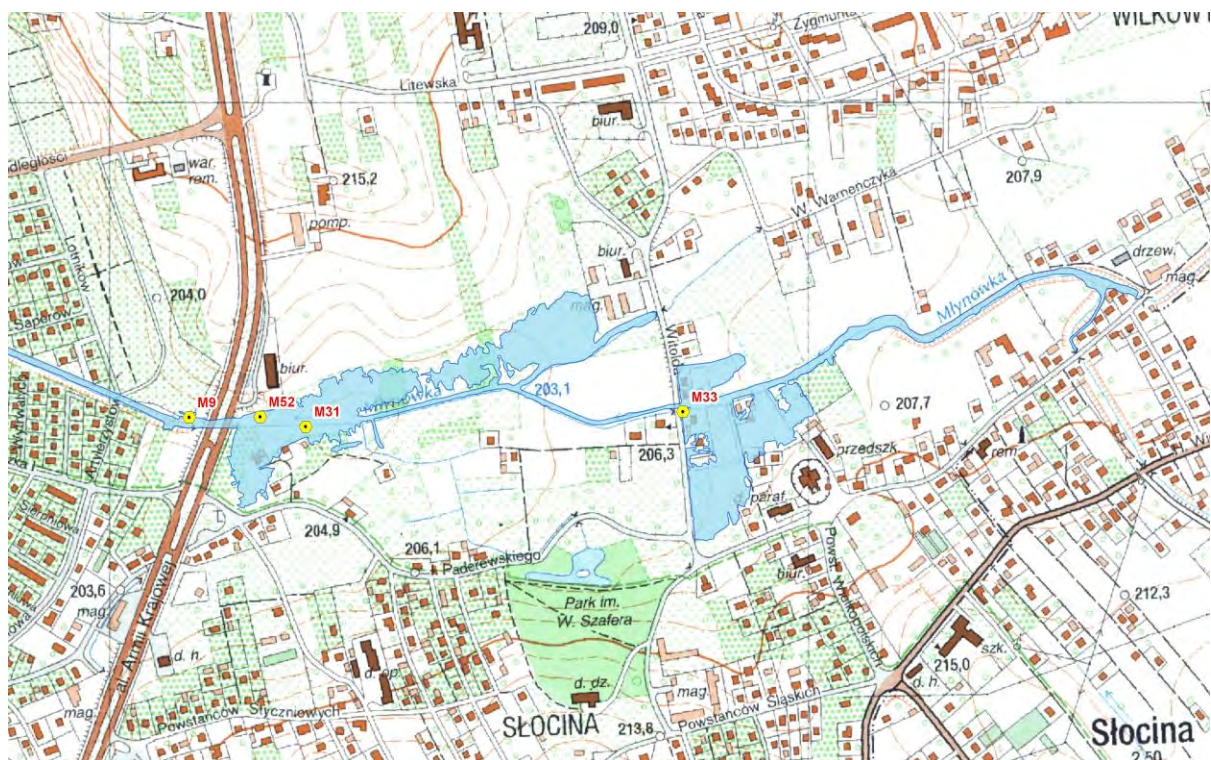
Ryc. 129. Lokalizacja wylotów kanalizacji deszczowej do potoku Młynówka
